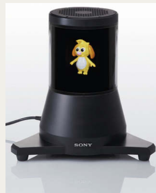
Dit volumetrische display van Sony gebruikt leds om een ruimtelijk beeld te creëren.
